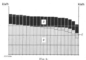
Valorisation par l'énergie thermique de l'énergie des usines au fil de l'eau interconnectées avec des usines à accumulation (20 semestres d'hiver)
