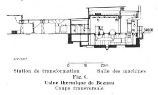
Les figures 5 et 6 montrent la situation et la disposition générale de l'usine thermique que les Forces Motrices du Nord-Est de la Suisse construisent selon le projet du Professeur Bruno Bauer, à proximité immédiate de leur usine à basse chute de Beznau. Elle comportera deux installations, l'une de 13 000 kW, l'autre de 27 000 kW. Les frais d'aménagement atteindront, paraît-il, 16 millions de francs. La première unité doit être mise en service pour l'hiver 1947/48, la seconde l'année suivante.
