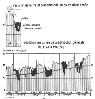
a énergie au fil de l'eau N énergie normale  $\begin{array}{ll} b & \text{\'energie d'accumulation} \\ E & \text{restrictions de consommation} \end{array}$
