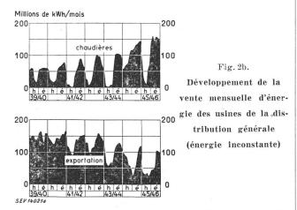
nergie en été qu'en hiver. Durant l'hiver 1944/45, où les débits des cours d'eau furent exceptionnellement élevés, les chaudières ont pu être alimentées sans interruption, au moins partiellement. En raison de la pénurie de combustibles, les chaudières électriques se sont considérablement développées. Inversement, les exportations d'énergie électrique
