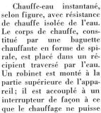
être enclenché que lorsque le robinet est ouvert. Raccordement au réseau par un cordon à trois conducteurs muni d'une fiche 2 P + T et fixé à demeure.
