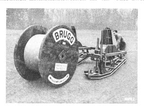
Fig. 1. Kabelwagen bereit zum Aufladen einer Kabelrolle
