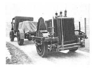
Fig. 3. Kabelwagen als Tiefgangwagen benützt
