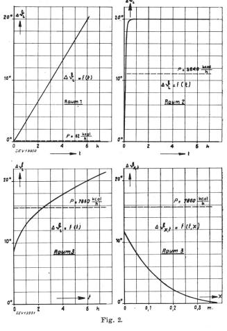
tig. Es muss in diesem Fall nur die Forderung gestellt werden, dass  $t_e < t_d$ , wo  $t_d$  die Heizdauer ist, bei welcher in der Tiefe d, welche der Mauerdicke entspricht, ein bestimmter maximaler Temperaturzuwachs, z. B. 1 ° C, gemäss (14) auftritt.
