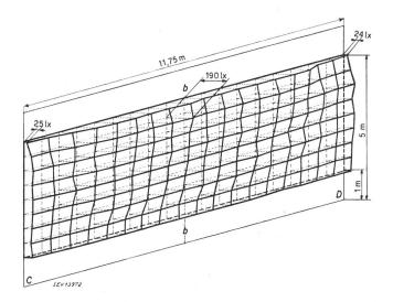
$Fig. \, 5f.$  Lichtverteilung an der Wandfläche C—D  $im \ grossen \ Oberlichtsaal \ bei \ künstlicher \ Beleuchtung \\ E_{min} = 24 \ lx \qquad E_{med} = 115 \ lx \qquad E_{max} = 190 \ lx$
