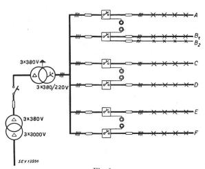
Fig. 1. Prinzipschema der Verteilanlage
