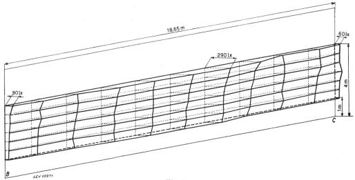
Fig. 5e. Lichtverteilung an der Wandfläche B-C im grossen Oberlichtsaal bei künstlicher Beleuchtung  $E_{\sf max}\,=\,290~{
