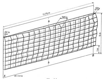
$\begin{array}{c} {\rm Fig.\,5d.} \\ {\rm Lichtverteilung\,\,an\,\,der\,\,Wandfl\"{a}che\,\,A-B} \\ {\rm im\,\,grossen\,\,Oberlichtsaal\,\,bei\,\,k\"{u}nstlicher\,\,Beleuchtung} \\ E_{\rm min} = 24\,\,{\rm lx}, \quad E_{\rm med} = 129\,\,{\rm lx}, \quad E_{\rm max} = 195\,\,{\rm lx} \end{array}$
