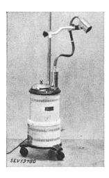
Description: Appareil, selon figure, pour la production de vapeur ionisée et chargée d'ozone, destinée aux soins de beauté ou aux soins médicaux. La vapeur est produite dans une bouilloire et l'ozone par un éclateur alimenté par un rupteur et un transformateur Tesla. Celui-ci est fixé, avec l'éclateur, à l'extrémité d'un tuyau conduisant la vapeur, relié à la bouilloire. Raccordement au réseau par un cordon à trois conducteurs muni d'une fiche 2 P+T.
