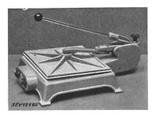
Description: Dispositif pour coller à chaud des photographies sur du carton, à l'aide de minces feuilles de papier collant. La résistance de chauffe est fixée sous la plaque de base, en fonte grise. La plaque mobile, en métal léger, a les dimensions de  $400 \times 400$  mm. La puissance de chauffe est réglable en trois échelons. Un régulateur de température, une lampe témoin et une fiche d'appareil 6 A 250 V sont en-
