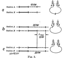
Abhängige Strompause bei zweifacher Einspeisung
