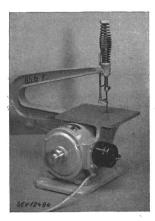
Description: Petite scie mécanique, selon figure, entraînée par un moteur monophasé blindé à induit en court-circuit avec phase auxiliaire. Mise en marche par un interrupteur avec position de démarrage, fixé au bâti; raccordement au réseau par un cordon torsadé à trois conducteurs, muni d'une fiche 2P+T.
