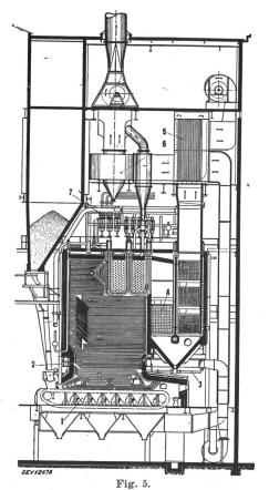
Sulzer-Hochdruck-Einrohrkessel von 55 t/h, 140 kg/cm $^2$  abs. Druck, 500° C
