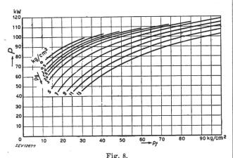
Gegendruck-Dampfmaschinen SLM-Winterthur Erzeugbare Leistung P für einen Dampfdurchsatz von 1000 kg/h in Abhängigkeit von Frischdampfdruck  $p_{\theta}$  und Gegendruck  $p_{\theta}$
