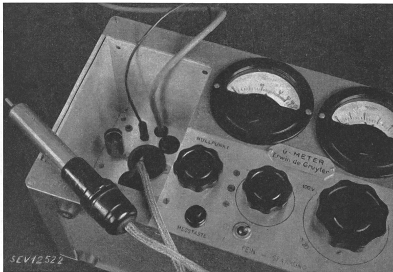
Fig. 13. Ansicht eines Kompensations-Röhrenvoltmeters mit eingebautem Netzanschlussgerät
