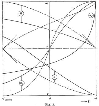
Scheitelspannungskorrekturfaktor  $\sigma$  und Differenzspannungswert  $u_{\rm d}$
