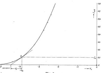
Fig. 6. Die kubische Parabel als Trioden-Ersatzkennlinie  $I=20(U+5,61)^2~\mu\,\mathrm{A}$  Die gemessenen Werte sind mit Kreisen bezeichnet.
