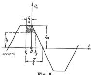
Eine trapezförmige Spannung wird mit dem KV gemessen (vgl. Fig. 2)
