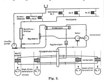
Schema der Wärmepumpen-Anlage
