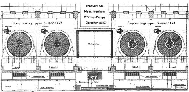
Fig. 6. Wärmepumpen-Anlage Maßstab 1:250
