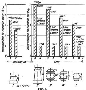
Isolationsbemessung von Innenraumstützern von 10 kV
