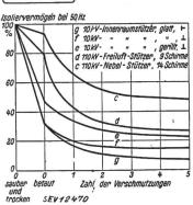
Fig. 3. Absinkkurven des Isoliervermögens bei 50 Hz von Stützern mit verschieden geformten Oberflächen
