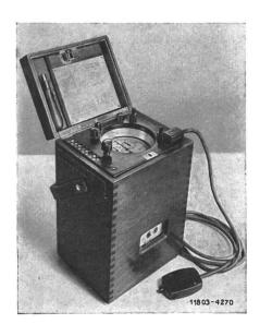
Fig. 1. Zwelsystem-Eichzähler für Wechsel- und Drehstrom neuester Bauart der Firma Landis & Gyr A.-G., Zug.
