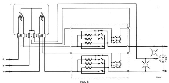
Anschluss-Schema eines Zweisystem-Dreileiter-Eichzählers für Drehstrom (Aron-Schaltung)
