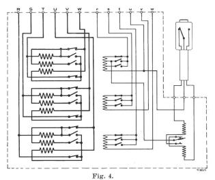
Schaltung eines Dreisystem-Eichzählers für Drehstrom mit elektrischer Zählwerksauslösung (Landis & Gyr)
