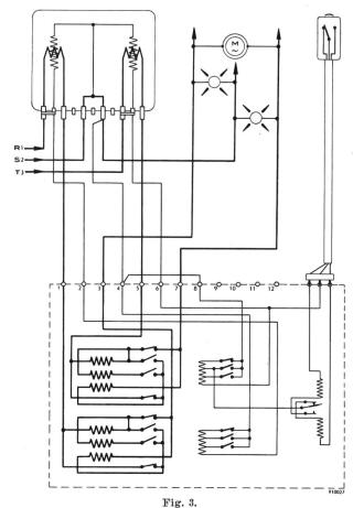
Anschluss-Schema eines Zweisystem-Eichzählers für Drehstrom mit elektrischer Zählwerksauslösung (Aron-Schaltung)
