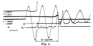
Oszillogramm aus der zweiten Versuchsreihe 1 Kontaktunterbrechung.  $t_{a}$  Lichtbogenzeit.  $p_{1}$  Druck in der Luft 4 kg/Stufe.  $p_{0}$  Druck im Oel pro Stufe 5 kg/cm<sup>2</sup>.
