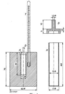
Fig. 1. Apparatur zur Prüfung der Zersetzungstemperatur organischer Isoliermaterialien
