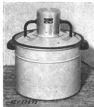
Description: Machine à laver selon figure. Un moteur monophasé à induit en court-circuit, fixé au couvercle de la cuve en aluminium, entraîne le dispositif de lavage disposé dans la cuve, par l'intermédiaire d'un réducteur de vitesse. Le dispositif de lavage décrit des mouvements rotatifs alternés. Le moteur est monté dans un boîtier avec ventilation interne et est dimensionné pour une durée de service de 15 minutes.
