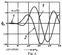
Ein typisches Beispiel für die Darstellung des komplexen Ablenkungskoeffizienten  $\Phi$ s in einem sinusförmigen Ablenkfeld. a=2.51 Reell. 2 Imaginär.
