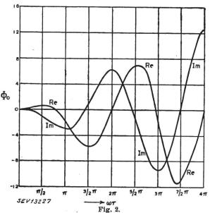
Der von der Frequenz abhängige Anteil der Funktion  $\Phi_0$  in einem unendlich ausgedehnten Transversalfeld in Abhängigkeit von  $\omega \tau$   $Im \quad Imaginärer Anteil.$   $Re \quad Reeller \quad Anteil.$
