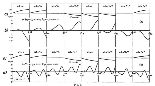
Beispiele von Strahlprofilen mit gleichzeitiger Darstellung der in den entsprechenden Zeitpunkten vorhandenen räumlichen Verteilung des Ablenkfeldes
