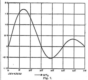
Frequenzabhängiger Teil der Gleichung (18) für ein sinusförmiges Ablenkfeld mit a=1
