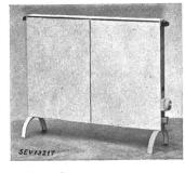
Description: Radiateur selon figure. La résistance de chauffe est logée dans deux tubes de fer coudés en forme de U et montés dans la partie inférieure d'un boîtier ventilé (paroi chauffante) en tôle d'aluminium. L'interrupteur de réglage et la fiche d'appareil sont fixés sur un côté, au bas de l'appareil.
