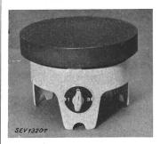
Description: Réchaud selon figure, comprenant une plaque en fonte de 193 mm de diamètre montée sur un socle en fonte de métal léger dont la partie inférieure est fermée par une plaque en tôle, ainsi qu'un interrupteur de réglage monté sous le socle et une fiche d'appareil fixée à l'appareil. Le fil résistant est noyé dans une masse spéciale.
