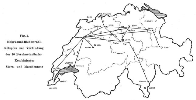
Kanäle kein Mass für den Mehraufwand an Apparaturen. Für die zentrale Relaisstation ergibt sich aber zweifellos eine wesentliche Vereinfachung, wenn gewisse Verbindungen direkt geführt werden. Unter Umgehung des Sternpunktes können die Verbindungen Genf-Lausanne, Olten-Luzern, Zürich-
