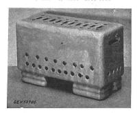
Description: Radiateur selon figure, avec bâti en matière céramique émaillée, à parois épaisses. Le fil résistant, enroulé en boudin, est bobiné sur deux cylindres superposés et est protégé par du treillis contre les contacts fortuits. Un interrupteur de réglage à bascule est encastré sur l'un des côtés à la partie inférieure du radiateur; une fiche d'appareil est fixée sur le côté opposé.
