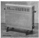
Description: Radiateur selon figure. Le fil résistant, enroulé en boudin, est fixé sur une plaque d'éternite renforcée par un cadre en tôle; celle-ci est montée dans un bâti en tôle dont elle est isolée par des pièces en matière céramique. Le bâti est ventilé. Deux interrupteurs à bascule et une fiche d'appareil sont montés sur le côté de l'appareil.
