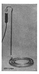
Description: Plongeur pour chaudron à fourrage, selon figure. Le tube chauffant, muni d'une enveloppe métallique, est enroulé en spirale avec ligne d'alimentation dans l'extrémité du tube (perpendiculaire à la spirale). Le plongeur est pourvu d'une poignée isolante à l'intérieur de laquelle se trouvent les bornes de raccordement. Raccordement au réseau par un cordon pour appareils mobiles, pénétrant dans l'appareil au travers d'un presse-étoupe.
