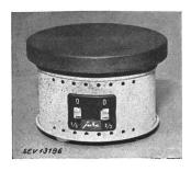
Description: Réchaud selon figure, comprenant une plaque en fonte de 180 mm de diamètre montée sur un socle en tôle, deux interrupteurs à bascule encastrés et une fiche d'appareil fixée au socle. La résistance de chauffe est noyée dans une masse spéciale.
