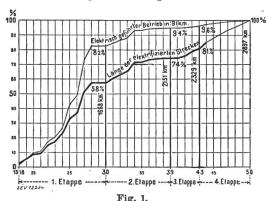
Entwicklung des elektrischen Betriebes auf dem Netz der SBB
