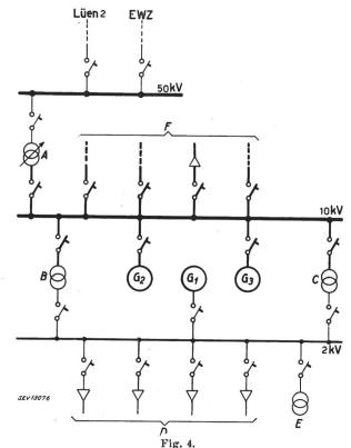
Vereinfachtes Prinzipschema des Kraftwerkes Sand Die Trenner und Messwandler wurden weggelassen.
