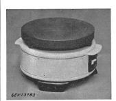
Description: Réchaud selon figure, comprenant une plaque en fonte de 180 mm de diamètre montée sur un socle en tôle muni de pieds en matière isolante moulée, ainsi qu'un interrupteur de réglage à bascule et une fiche d'appareil encastrés. La résistance de chauffe est logée dans une masse spéciale.
