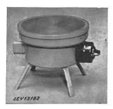
Description: Réchaud selon figure, comprenant une plaque en fonte de 198 mm de diamètre, montée sur un socle en tôle, ainsi qu'un interrupteur de réglage et une fiche d'appareil fixés au socle. La résistance de chauffe est logée dans une masse spéciale.
