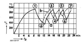
Fig. 13. Temperatur des Brenngutes beim Puderverfahren
