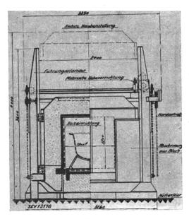
Fig. 14. Spezial-Elektro-Emaillierofen für das Einbrennen von grossen gusseisernen Waschkesseln nach dem Puderverfahren Haubenofen mit rundem Ofenraum, Ø 1,2 m. Anschlusswert 120 kW.
