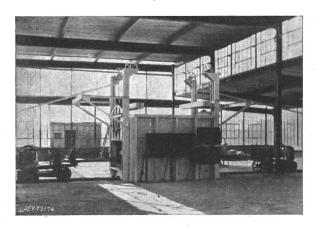
Fig. 10. Amerikanische Elektrokammerofen-Anlage für das Emaillieren von Ofenbestandteilen
