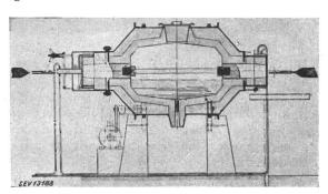
Fig. 3. Schnitt durch Elektro-Trommel-Schmelzofen mit wassergekühlten Stromzuführungen für Temperaturen bis 1650...1800° C. Beheizung durch axial angeordneten Graphit-Heizstab.
