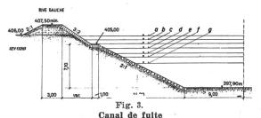
Coupe transversale à la sortie des turbines  $Q_u$  débit utilisé.  $Q_R$  débit dans le Rhône.
