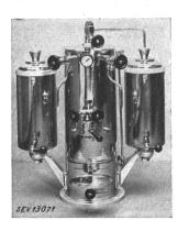
Description: Percolateur, selon figure, avec corps de chauffe isolés de l'eau. Le réservoir d'eau est maintenu sous pression à des températures supérieures à 1000 C par des corps de chauffe et un régulateur de pression. Le percolateur comprend des accessoires pour la préparation du café, pour soutirer de l'eau chaude ou de la vapeur ainsi qu'une soupape de sûreté, un manomètre, un indicateur de niveau d'eau et un dispositif de sûreté contre l'échauffement anormal. Les deux réser-
