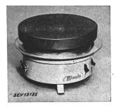
Description: Réchaud selon figure, comprenant une plaque en fonte de 180 mm de diamètre montée sur un socle en tôle, un écran en tôle placé entre le socle et la plaque ainsi que deux interrupteurs à bascule et une fiche d'appareil encastrés dans le socle. Le fil résistant est noyé dans une masse spéciale.
