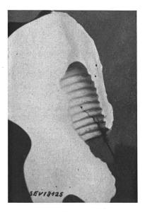
Fig. 3. Fissure dans le trou de fixation du support
