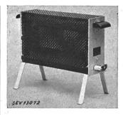
Description: Radiateur selon figure. Les spirales de chauffe sont tendues entre des barres d'éternite. Le bâti est en fonte et en tôle ajourée; les pieds sont en fer plat. Le raccordement du cordon d'alimentation s'effectue par une fiche d'appareil.
