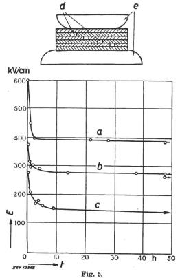
Die Abhängigkeit der Durchschlagsspannung E von der Zeit t bei Dielektrika aus Papier
