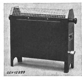
Description: Radiateur selon figure. Les spirales de chauffe sont fixées sur une plaque d'éternite rentôle; celle-ci est montée dans un bâti en tôle dont elle est isolée par des pièces en matière céramique. Les parties supérieure et inférieure du bâti sont fermées par du treillis. L'appareil possède un interrupteur de réglage
