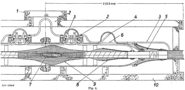
Schnitt durch ein Einleiterkabel von 132 kV Nennspannung mit Gasfüllung
