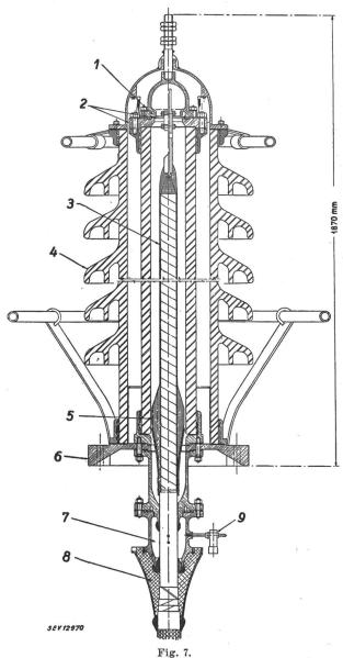
Schnitt durch einen Kabelendverschluss von 132 kV
