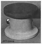
Description: Réchaud selon figure, comprenant une plaque en fonte de 180 mm de diamètre, montée sur un socle en tôle émaillée. La résistance de chauffe est logée dans une masse spéciale. Un interrupteur de réglage à 4 positions (0, 4, 3, 1) et une fiche d'appareil sont encastrés dans le socle.
