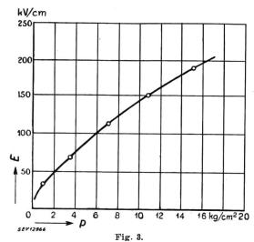
Die Ionisationsspannung E eines Einleiterkabels mit Gasfüllung in Abhängigkeit vom Gasdruck pTemperatur des als Gas verwendeten Stickstoffes 15° C
