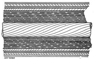
Fig. 2. Längsschnitt durch ein Einleiterkabel mit Gasfüllung
