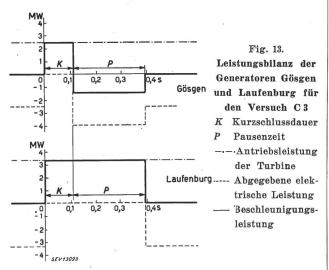
Wenn auf diese Art die Belastungen während der Kurzschluss- und Pausenzeit bestimmt werden, erhält man eine Leistungsbilanz wie sie beispielsweise für den Versuch C 3 in Fig. 13 graphisch dargestellt ist. Aus den dort ermittelten Beschleunigungsleistungen lassen sich dann sehr leicht die Aenderungen der Winkelgeschwindigkeit (d. h. der Schlupf)
