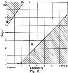
Stabilitätsberechnung für die dreipoligen Kurzschlüsse mit Schnellwiedereinschaltung
