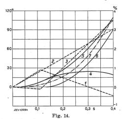
Schlupf und Winkeländerung der beiden Generatoren während Kurzschluss- und Pausenzeit beim Versuch C 3
