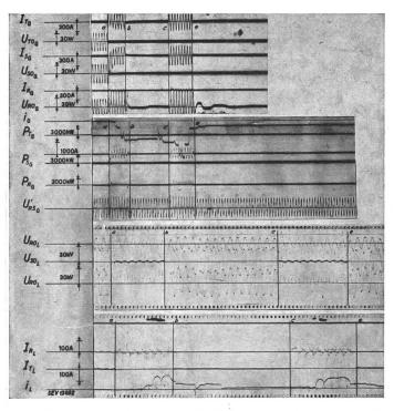
tung II nach der Wiedereinschaltung definitiv unterbrechen mussten. Bei diesen Versuchen war die Leitung I offen; die beiden Generatoren waren unbelastet. Fig. 12 zeigt als Beispiel einen zweipoligen festen Erdkurzschluss auf den Phasen S und T mit dreipoliger Unterbrechung, Wiedereinschaltung und definitiver Abschaltung.
