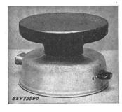
Description: Réchaud selon figure, comprenant une plaque en fonte de 180 mm de diamètre montée sur un socle en tôle de 110 mm de haut, ainsi qu'un interrupteur de réglage encastré et une fiche d'appareil fixée au socle. Le fil résistant est noyé dans une masse spéciale.
