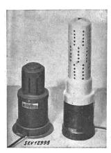
Description: Appareil pour la production d'ozone, selon figure, comprenant un transformateur de faible puissance à haute tension et une lampe à effluve à deux électrodes. Le boîtier est en matière isolante moulée, le capot de protection en tôle. Un coupe-circuit de dimension réduite est branché dans le circuit primaire du transformateur. Raccordement au réseau par un cordon à deux conducteurs, avec isolation résistant à l'action de l'ozone, muni d'une fiche.
