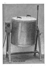
Description: Chaudron à fourrage basculant en tôle de fer zinguée, selon figure, monté sur un bâti. Capacité: 100 l. Chauffage par le fond. La boîte à bornes et l'interrupteur de réglage sont disposés sur le côté de l'appareil. Raccordement au réseau par un cordon à quatre conducteurs (3P+T) fixé à demeure. Le levier pour basculer le chaudron et le couvercle de celui-ci sont munis de poignées isolantes.
