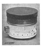
Description: Réchaud selon figure, comprenant une plaque en fonte de 200 mm de diamètre, un interrupteur de réglage encastré et une fiche d'appareil fixée sur le socle. La résistance de chauffe, noyée dans une masse spéciale, est fixée à la face inférieure de la plaque. De l'amiante en flocons, placé dans le socle en tôle, empêche le rayonnement de la chaleur vers le bas.
