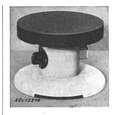
Description: Réchaud selon figure, comprenant une plaque en fonte de 220 mm de diamètre, montée sur un socle en tôle de 130 mm de haut, ainsi qu'un interrupteur de réglage encastré et une fiche d'appareil fixée au socle. Le fil résistant est noyé dans une masse spéciale.
