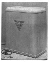
Description: Appareil, selon figure, pour l'enregistrement sur fil d'acier de conversations transmises par téléphone et pour prendre connaissance de celles-ci. Il est possible d'écouter après coup les communications transmises par le réseau téléphonique public. Cet appareil peut être aussi utilisé pour l'enregistrement de dictées. Ses parties principales sont: le raccordement au réseau, comprenant un amplificateur; divers relais, trois paires de bobines avec fil d'acier, un
