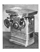
Description: Machine pour hâcher et émincer la viande, selon figure, entraînée par un moteur triphasé à induit en court-circuit, incorporé, Transmission par un réducteur de vitesse avec graissage automatique, monté dans la partie supérieure du socle en fonte. Les couteaux à hâcher et à émincer peuvent être embrayés et débrayés ensemble ou séparément. L'interrupteur est encastré dans le socle. Raccordement au réseau par un cordon à gaine de caoutchouc à quatre conducteurs, fixé à demeure.
