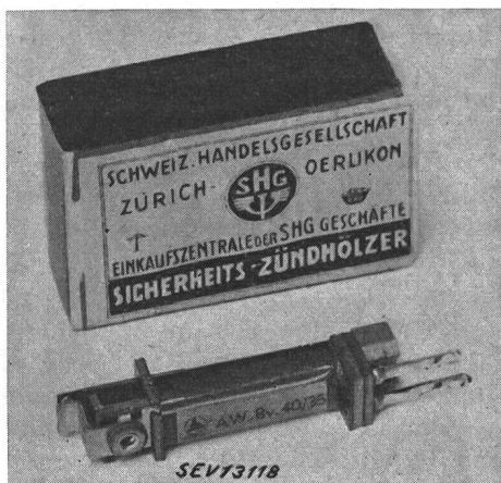
Fig. 5. Miniaturrelais des Impulswiederholers (Grössenvergleich mit einer Streichholzschachtel)
