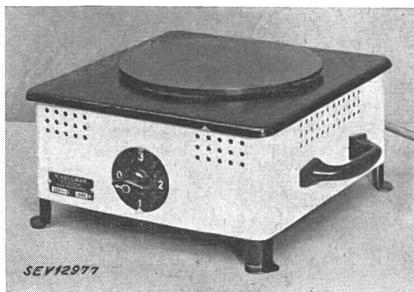
**Description:** Réchauds selon figure, comprenant une plaque en fonte de 180 mm de diamètre montée sur un socle en tôle de 123 mm de haut, ainsi qu'un interrupteur de réglage encastré et un cordon à gaine de caoutchouc à trois conducteurs muni d'une fiche 2P+T et fixé à demeure. Le fil résistant est noyé dans une masse spéciale.
