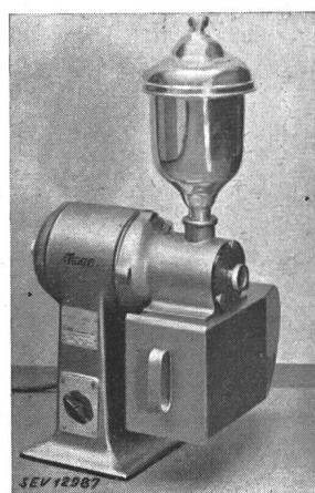
**Description:** Moulin à café, selon figure, entraîné par un moteur monophasé à induit en court-circuit, avec phase auxiliaire. Un interrupteur avec position de démarrage et une résistance de démarrage sont encastrés dans la base de l'appareil. Raccordement au réseau par un cordon à gaine de caoutchouc à trois conducteurs, muni d'une fiche 2P+T et fixé à demeure.
