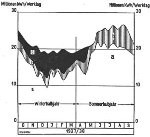
Fig. 3. Verlauf der Produktion aller schweizerischen Werke innerhalb eines Jahres
