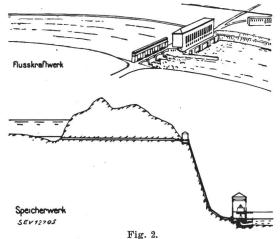
Grundsätzliche Darstellung eines Laufkraftwerkes und eines Speicherkraftwerkes
