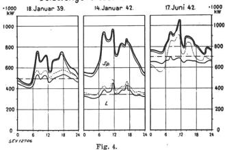
Der Ausgleich geht noch weiter, denn teilweise dienen die Exportleitungen in Zeiten von Niederwasser auch einem Import elektrischer Energie. Der Verlauf des Verbrauchs innerhalb 24 Stunden (Fig. 4) ist ebenfalls das praktische Ergebnis der gegenseitigen Anpassung von Angebot und
