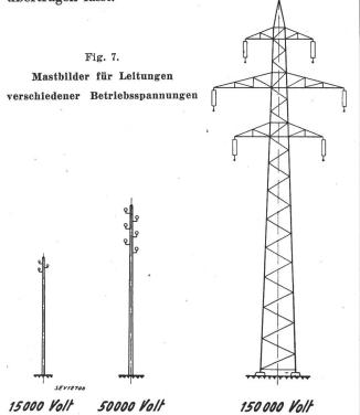
Massgebend für die Beurteilung der Leitungen ist die *Spannung*, die am einfachsten mit dem Druck zu vergleichen ist, mit dem eine Wasserleitung betrieben wird.
