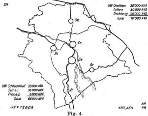
Puissance installée des sous-stations de Zurich
