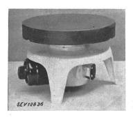
Description: Réchaud selon figure, comprenant une plaque de cuisson en fonte, de 220 mm de diamètre, montée sur un socle en fonte, ainsi qu'un interrupteur de réglage et une fiche d'appareil, disposés sous le socle. La résistance de chauffe est logée dans une masse.
