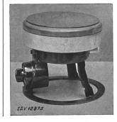
Description: Réchaud, selon figure, comprenant une plaque en fonte de 176 mm de diamètre, montée sur un socle en fonte et en tôle, ainsi qu'un interrupteur de réglage et une fiche d'appareil fixés au socle. La résistance de chauffe est logée dans une masse.
