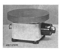
Description: Réchaud selon figure, comprenant une plaque de cuisson en fonte, de 200 mm de diamètre, montée sur un socle en tôle dont la partie inférieure est fermée par une plaque d'éternite, ainsi qu'un interrupteur de réglage et une fiche d'appareil, fixés sur le socle. La résistance de chauffe est logée dans une masse.
