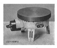
Description: Réchaud, selon figure, comprenant une plaque en fonte de 180 mm de diamètre, montée sur un socle en fonte muni de pieds en tôle, ainsi qu'un interrupteur de réglage et une fiche d'appareil fixés au socle. La résistance de chauffe est logée dans une masse.
