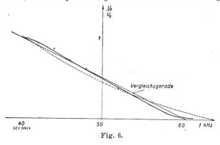
die ausgezogene Kurve der Messung. Es geht daraus hervor, dass der Diskriminator fast verzerrungsfrei arbeitet. Der Abschlusswiderstand in der Schaltung stellt den Gleichrichterersatzwiderstand dar,
