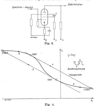
durch die Störwirkungen vermindert werden. Auf der Anodenseite des Begrenzers sind die Impulse negativ, was die richtige Lage für die Steuerung der von mir verwendeten Kippvorrichtung ist, Die Kippvorrichtung stellt einen selbsttätigen Kippgenerator dar. Die Schwingungen entstehen durch Verteilung des Stromes zwischen Anode und Schirm-
