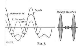
gegeben. Die Amplitude der zweiten Harmonischen beträgt dabei die Hälfte derjenigen der ersten. Der beim Vorhandensein von nur zwei Harmonischen entstehende kleine Zwischenimpuls kann sich wegen seiner Kleinheit nicht störend auswirken und wird ausserdem im Empfänger durch den Amplitudenbegrenzer ausgesiebt. Als Impulsfrequenz wurde 50 kHz gewählt. Dabei konnte eine Tonfrequenz von 10 kHz noch übertragen werden. Der Frequenzhub betrug 10 kHz, also 20 % der Grundfrequenz.
