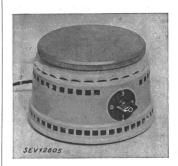
Description: Réchaud, selon figure, comprenant une plaque en fonte de 185 mm de diamètre, montée sur un socle en tôle dont la partie inférieure est fermée, un interrupteur de réglage incorporé et un cordon d'alimentation torsadé muni d'une fiche 2 P + T et fixé à demeure. La résistance de chauffe est novée dans une
