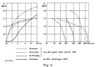
Magnetisierungskurven und Abhängigkeit der reversiblen Permeabilität von der Gleichflußsättigung für verschiedene Membranbleche
