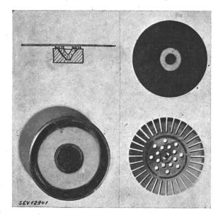
Fig. 4. Mikrophon mit kegelförmiger Elektrode (Lorenz)
