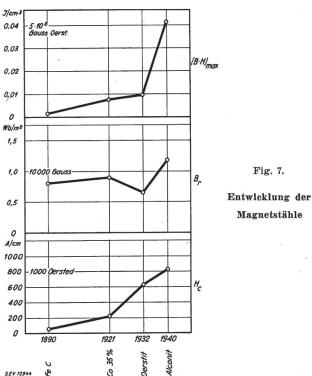
stark gehemmt. Um kleine Abmessungen und geringes Gewicht des Hörers zu erhalten, sollen alle Teile bestens ausgenützt werden, wobei die neuesten magnetischen Materialien zur Verwendung gelangen müssen. Für die permanenten Magnete zeigt Fig. 7 die Kennwerte für vier typische Vertreter der Entwicklungsstufen <sup>6</sup>). Die neuen ausscheidungsgehärteten Magnetstähle hoher Leistung lassen sich nur
