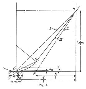
Ideelles Potentialdiagramm für den Polwinkel  $b/_{ au}=0,66$
