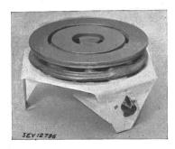
Description: Réchaud selon figure, composé de deux plaques annulaires en tôle d'acier, de 137 et 220 mm de diamètre extérieur. Le socle en tôle a 95 mm de hau-teur. Une fiche d'appareil et un interrupteur de réglage à 4 positions (0, 1, 2, 3) sont encastrés dans le socle. Sur la position 1, l'anneau intérieur seul est enclenché et sur la position 2 l'anneau extérieur seul est enclenché.
