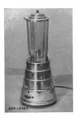
Description: Machines à mélanger pour boissons et aliments, selon figure, entraînées par un moteur série monophasé ventilé, monté dans un socle métallique. L'agitateur, monté dans un récipient en verre, est entraîné par l'intermédiaire d'un accouplement élastique fixé au moteur. Un interrupteur avec position de démarrage est encastré dans la base de l'appareil. Le cordon d'alimentation, muni d'une fiche 2 P + T, est fixé à de-
