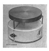
Description: Réchaud, selon figure, comprenant une plaque de cuisson en fonte de 198 mm de diamètre, montée sur un socle en fer, ainsi qu'un interrupteur de réglage et une fiche d'appareil, encastrés dans le socle. La résistance de chauffe est logée dans des perles en matière céramique.
