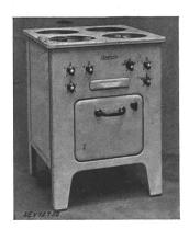
Description: Cuisinière de ménage à quatre plaques et four dans le socle, selon figure. Le corps de chauffe supérieur du four est monté dans celui-ci; le corps de chauffe inférieur est monté à l'extérieur du four. Cette cuisinière possède des prises de courant pour plaques de cuisson normales, des bornes permettant divers couplages et un cordon d'alimentation fixé à demeure.
