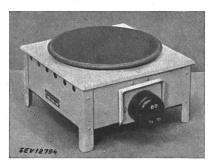
Description: Réchaud, selon figure, comprenant une plaque en fonte avec surface de chauffe plane de 185 mm de diamètre, montée sur un socle en tôle. La résistance de chauffe est noyée dans une masse. Un interrupteur de réglage à bascule et une fiche d'appareil sont montés sur le réchaud.
