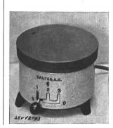
Description: Réchaud, selon figure, comprenant une plaque en fonte de 180 mm de diamètre montée sur un socle en tôle émaillée dont la partie supérieure et inférieure sont fermées. La résistance de chauffe est noyée dans une masse. Un interrupteur de réglage est encastré dans le socle. Le cordon d'alimentation, muni d'une fiche 2P+T, est fixé à demeure.
