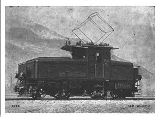
Fig. 2. Rangierlokomotive der Rhätischen Bahn nach dem Umbau
