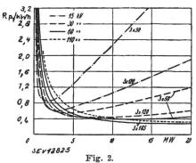
Spez. Uebertragungskosten in Abhängigkeit von der Höchstleistung Einfachleitungen, 20 km, Benützungsdauer 4380 h.
