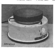
Description: Réchaud, selon figure, comprenant une plaque de cuisson en fonte, d'un diamètre de 180 mm, fixée à demeure sur un socle en tôle émaillée dont la base est fermée. Cet appareil possède un interrupteur de cuisinière encastré et un cordon d'alimentation muni d'une fiche 2P+T, fixé à demeure.
