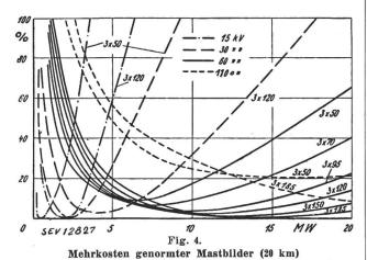
Projektiert man die Leitungen nach diesen Zusammenhängen, so wird neben der technischen stets auch eine wirtschaftliche Reserve vorhanden sein, indem die Leitungen ohne Erhöhung der spezifischen Uebertragungskosten noch stärker belastet werden können. Greift man aus jeder Kurve das Stück heraus, innerhalb dessen die von ihr dargestellte Leitung die billigste ist, so erhält man einen Linienzug, der in seinem Grundverlauf den beiden Kostenkurven von Fig. 1
