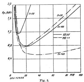
Spez. Uebertragungskosten in Abhängigkeit von der Höchstleistung Einfachleitungen, 100 km, Benützungsdauer 4380 h.
