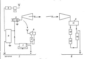
Fig. 2. Schema der LMT-Mehrkanalrichtstrahlverbindung mit em-Wellen
