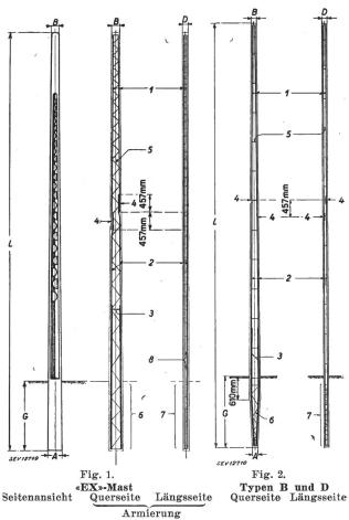
Aus den Versuchsergebnissen wurde ermittelt, dass der Bruch bei einer Zugspannung von ungefähr 4100 kg/cm² eintrat. Diese Zugbeanspruchung entspricht der Bruchgrenze
