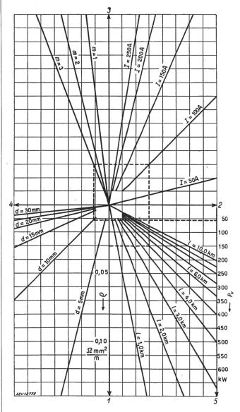
Fig. 6. Kupferverlust einer Leitung
