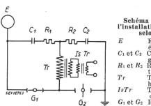
Fig. 8. Schéma de couplage de l'installation de redresseurs selon la figure 7
