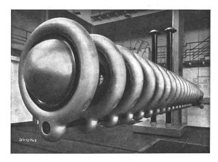
Fig. 1. Vue d'un redresseur pour 1200 kV
