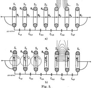
Principe de fonctionnement du redresseur a) Moment de la transmission du courant (en haut) b) Moment du blocage (en bas)
