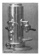
Description: Percolateur, selon figure, dont les parties sous tension sont normalement en contact avec l'eau. L'eau est chauffée dans un récipient, isolé des autres parties métalliques, dans lequel des électrodes sont introduites. Le percolateur comprend des accessoires pour la préparation du café, pour soutirer de l'eau chaude et de la vapeur ainsi qu'un thermomètre à aiguille, un interrupteur et des lampes témoins. La ligne d'alimentation est fixée à demeure.
