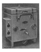
Description: Appareil de cuisson universel, mobile, selon figure, pour grandes cuisines, boucheries et exploitations semblables. Cet appareil comprend une chaudière calorifugée, en métal léger, avec chauffage par le fond, ainsi que deux interrupteurs de réglage, un régulateur de température et un contacteur, encastrés, Le raccordement du cordon d'alimentation s'effectue par une fiche d'appareil.
