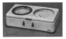
Description: Réchaud en fonte émaillée, selon figure, pour plaques de cuisson normales ayant au max. 220 mm de diamètre. Le réchaud est fermé par une plaque de tôle à sa partie inférieure et possède des interrupteurs de cuisinière encastrés, ainsi que des bornes pour le raccordement en courant monophasé ou triphasé et pour la mise à la terre. Un cercle intermédiaire en fonte grise permet d'utiliser des plaques de 180 mm.
