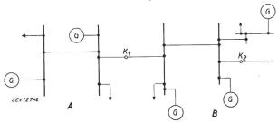
Fig. 1. Prinzipielles Netzbild  $K_1$  Kuppelstelle der Netze A und B, je mit Kraftwerken und Verbrauchszentren.
