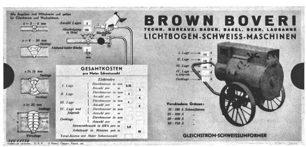
Fig. 8. Rechenschieber zur Kostenberechnung geschweisster Konstruktionen
