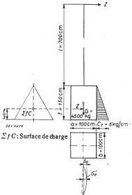
point d'application de ces efforts au-dessus du sol et la profondeur du massif ne soit pas inférieur à 5 environ. En réalité, le massif de fondation est également soumis à un effort transversal qui dépend de la force appliquée au sommet du support. On pouvait admettre avec raison que les résistances de frottement entre le massif et le terrain adjacent sont
