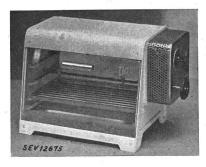
Description: Gril à broche tournante, grille et plaque de propreté selon figure. Des éléments chauffants à boudins incandescents sont disposés dans le haut. L'appareil est fermé sur ses faces antérieures et postérieures par des carreaux de verre. L'interrupteur de réglage, la fiche d'appareil et la poignée pour tourner la broche sont disposés sur les côtés.
