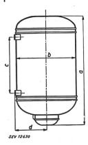
Description: Chauffe-eau à accumulation pour montage mural, selon croquis, comprenant un corps de chauffe et un régulateur de température avec dispositif de sûreté. L'appareil No. 2 est muni d'un thermomètre.
