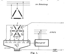
6-phasiger, selbstgeführter, fremdgesteuerter Wechselrichter
