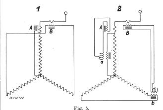
Uebersetzungs- und Winkelfehler-Korrektur eines Dreiphasenwandlers, Sekundärseite
