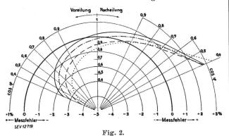
Prozentualer Gesamt-Messfehler bei einer Einphasen-Messung infolge der Einzelfehler von Strom- und Spannungswandler
