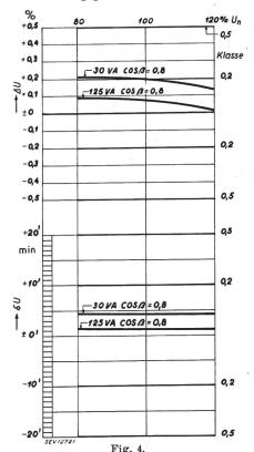
Messdaten eines 135-kV-Einphasen-Spannungswandlers mit Luftspalt
