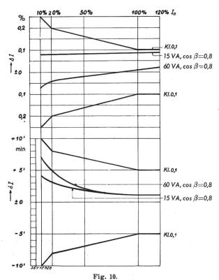
Messdaten eines 150-kV-Stromwandlers mit Doppelwicklung
