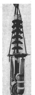
schleife wurde in ein mechanisch sehr festes Metallrohr verlegt und dort verkeilt. Der Rohrkörper ist quer zur Achse der Primärwindungen an einer Stelle aufgeschnitten und isoliert verschraubt, so dass darin keine Kurzschlussströme zirkulieren können, die sonst das Zustandekommen eines Stromes in der Sekundärwicklung verhindern würden. Diese Konstruktion hat sich als allen Anforderungen gewachsen erwiesen. Fig. 9 zeigt den aktiven Teil.
